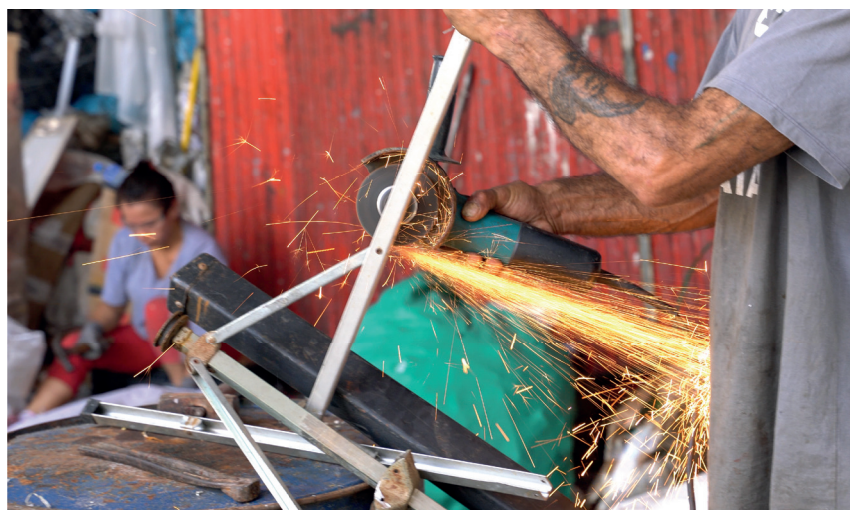
Catadores realizam diversos procedimentos antes de destinar os produtos à reciclagem. Acima, Lia, 50 anos, e sua filha retiram o conteúdo de embalagens aerossóis na Catamare, em Curitiba (PR); abaixo, lixadeira é utilizada em peças de metal.
