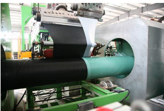
钢管防腐处理
